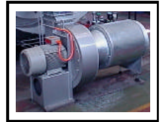
22kW Motor and Fan
